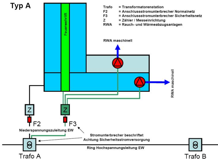
Sicherheitsstromversorgung für Gebäude **ohne** erhöhte Anforderungen wenn kein Mittel- oder Hochspannungsleitung - Ring vorhanden ist:
