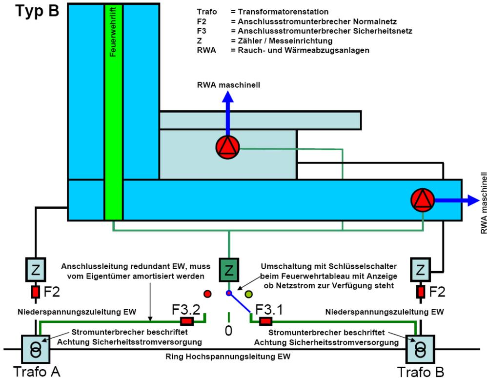
Sicherheitsstromversorgung für Gebäude **mit** erhöhten Anforderungen wenn kein Mittel- oder Hochspannungsleitung - Ring vorhanden ist:
